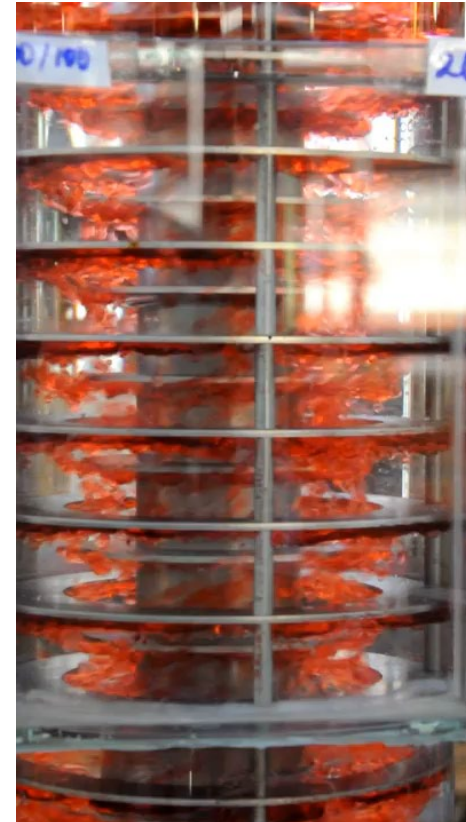
RDC colonne à disque rotatif
